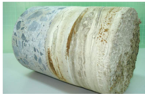
コンクリート床と注入した樹脂
